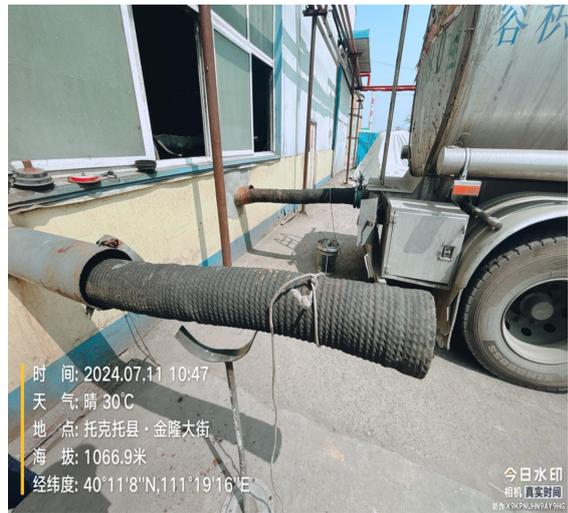
原料运输罐与生产车间原料储存池（搅拌池）管道输送
